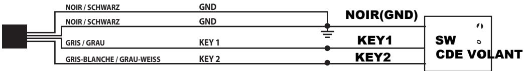
Le VM009 est intégré des commandes au volant Résistives. En cas d'incompatibilité, utiliser les interfaces 04083 - 04085. Pour les branchements aux connecteurs originaux de la voiture, suivre les schémas présents sur les instructions de connexion des interfaces.
