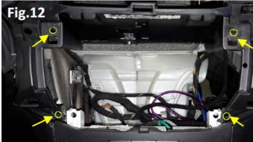
Remettre les clips Origine (Fig.7 et Fig.9) dans les trous élargis et sur les aérateurs (Fig.13).
