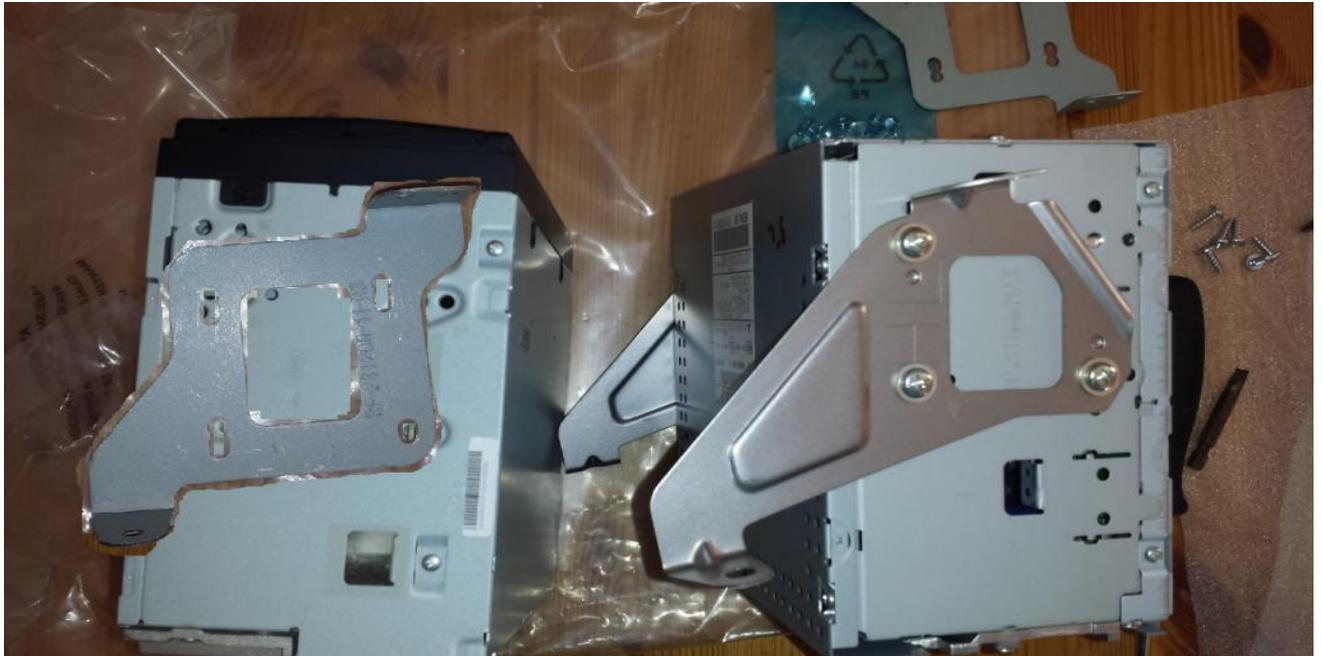
Ensuite il faut préparer l'autoradio il faut fixer les pattes de fixation fourni dans le kit sur les trous appeler T sur l'autoradio pioneer. Les pattes ce retrouve parallèle à la face avant.
