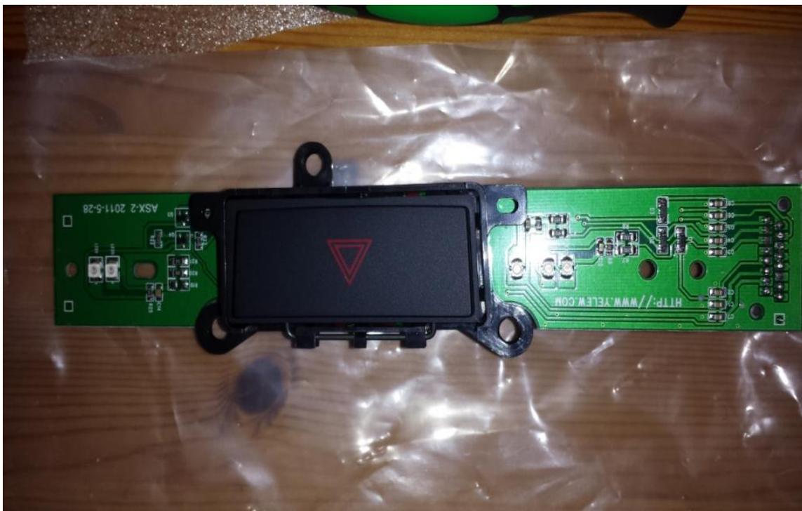
Remonter le bouton des warning sur le circuit fourni dans le kit.
