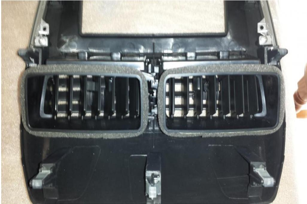
Il faut ensuite déclipser les aérateurs d'origine et le reclipser sur la nouvelle face avant.
