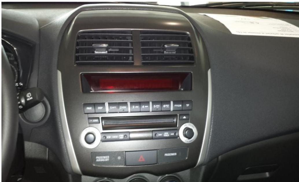
Tout d'abord la façade d'origine il faut la retirer en tirant sur le bas il n'y a pas de vis ( Les garagiste de la concession mon induit en erreur il disait qu'il fallait retirer les parties grises en premier surtout pas...)
