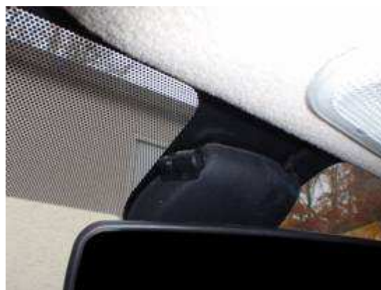
Fixer le micro à l'aide de sa patte de fixation
