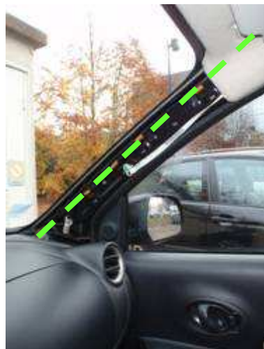
Passage du câble et fixation du micro
