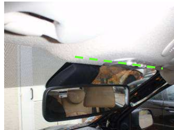
Passage du câble et fixation du micro
