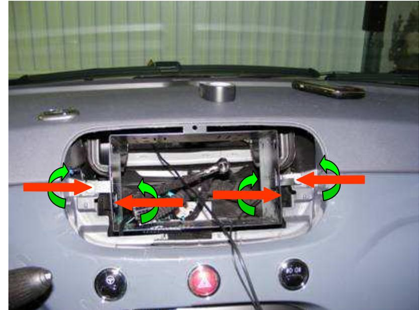
**Coller le carré de mousse puis positionner le cadre métallique et le fixer par quatre vis.**
