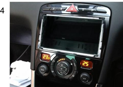
Fit the double din metal bracket.
