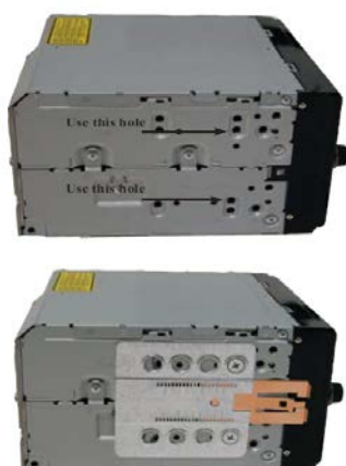
Montage des clips sur l'autoradio exemple sur un Pioneer.
