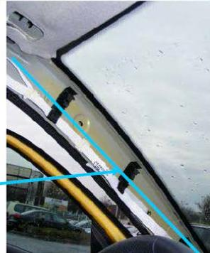
*Passage du câble du micro sous la garniture du montant avant gauche du Pare brise.*
