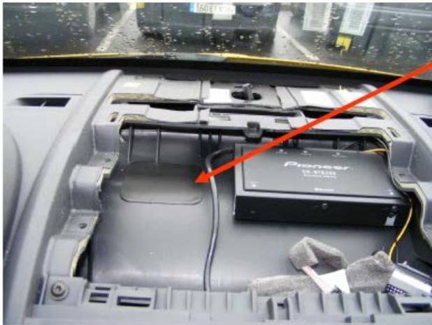
*Positionner l'antenne GPS sous le cache supérieur.*
