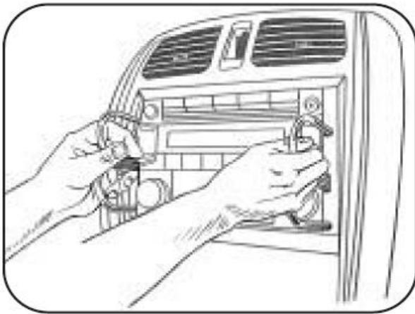
Pour le montage d'un autoradio Double Din veuillez prendre la façade Double Din (B) et couper la barre de séparation à l'aide d'un cutter.
