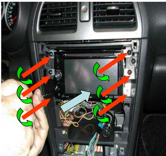
*Fixer l'autoradio à l'aide des 6 vis de fixation d'origine.*
