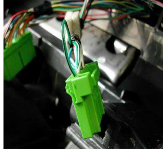
*Epissure, soudure, isolation. fil Rose Pioneer sur le fil Noir liseré Vert du contacteur C position 2.*
