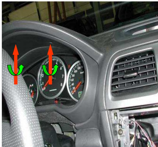
*Déposer l'entourage du compteur en dévissant deux vis.*
