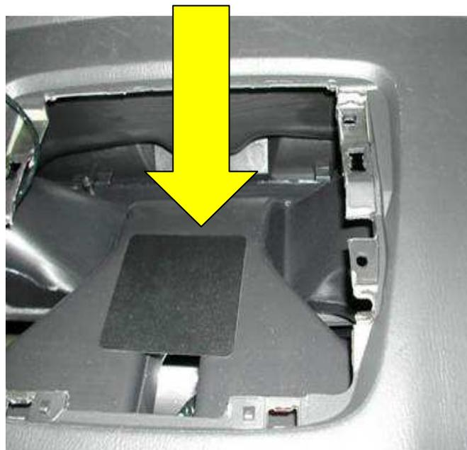
*Placer l'antenne sur la plaque métallique*
