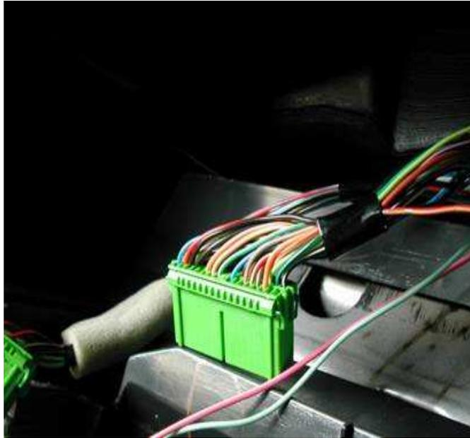
*Epissure, soudure, isolation. fil Vert Pioneer sur le fil Rouge liseré Jaune du contacteur B position 19.*
