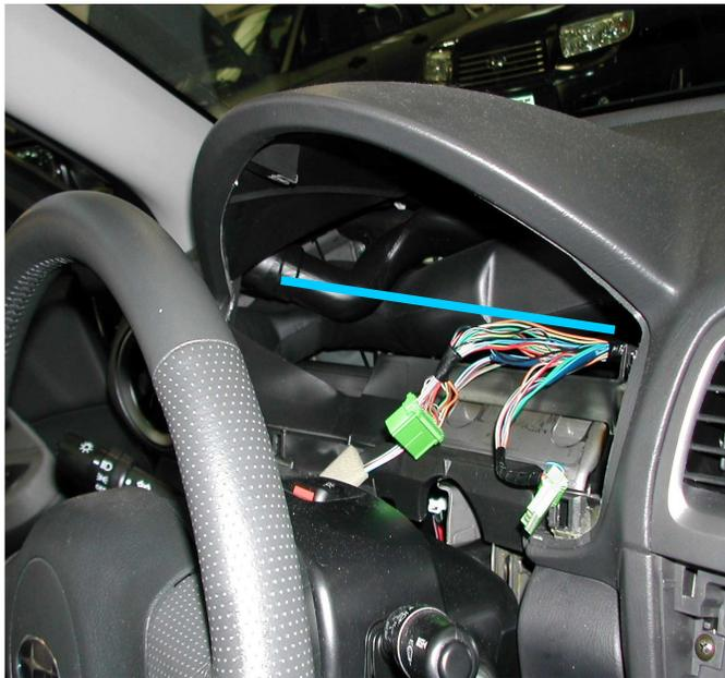
*Passage du câble du micro sous la garniture du montant avant gauche du par brise.*
