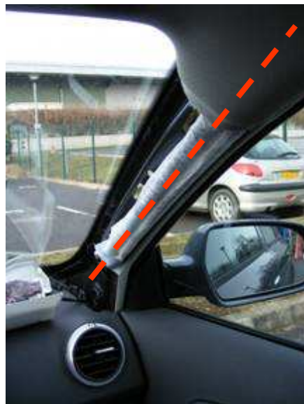
Passage du câble et fixation du micro
