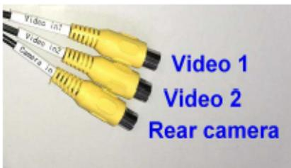
**Nous recommandons d'alimenter la caméra arrière par un ACC 12V stable au lieu de l'info marche arrière pour éviter toute distorsion vidéo de la caméra, surtout lorsque le moteur tourne!**
