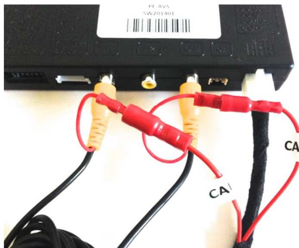
Caméra de recul branchée sur CAM1, et caméra Frontal branchée sur CAM2
