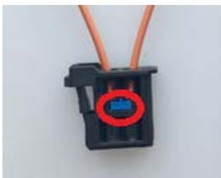
Retourner le connecteur et à l'aide d'un petit tournevis soulever la languette pour retirer la fibre optique.
