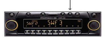
Appuyer sur la touche flèche en bas pour activer le « menu » et sélectionner « phone » et mettre en « ON »
