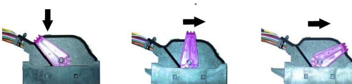
Pousser sur l'ergot Faîtes pivoter le levier de verrouillage jusqu'à l'autre extrémité.
