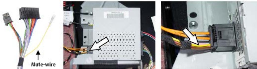
Le fil Jaune Mute se trouve sur le connecteur mâle du faisceau et doit être connecter sur le fil Jaune de mute de l'amplificateur situé sur le connecteur à 4 voies près des fibres optique de couleur orange.
