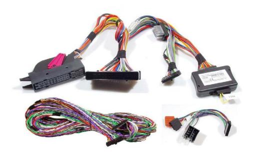
Le faisceau est toujours livré avec le boîtier mute à connecter entre l'ampli et son faisceau adaptateur ISO pour le KML et la rallonge de 5m.
