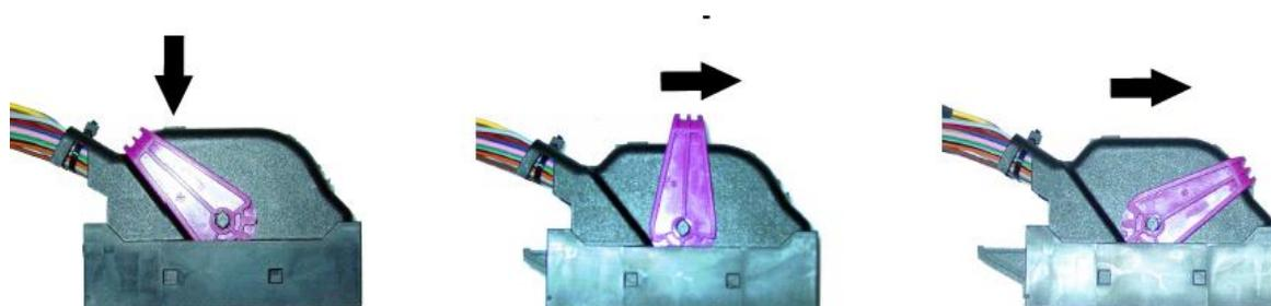
Pousser sur l'ergot. Faites pivoter le levier de verrouillage jusqu'à l'autre extrémité.
