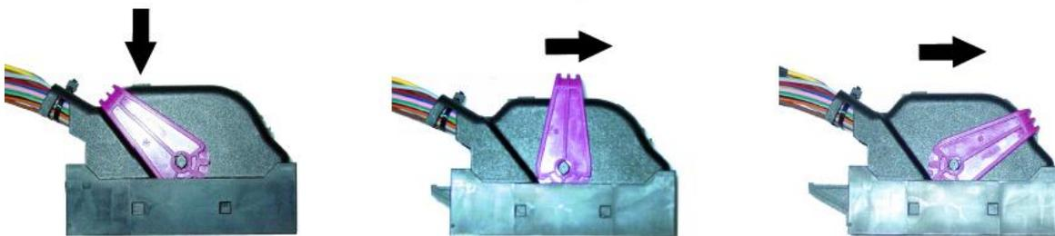
Pousser sur l'ergot Faîtes pivoter le levier de verrouillage jusqu'à l'autre extrémité.
