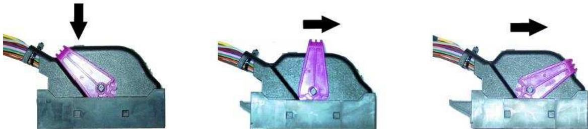
Pousser sur l'ergot Faites pivoter le levier de verrouillage jusqu'à l'autre extrémité.
