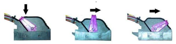
Pousser sur l'ergot Faîtes pivoter le levier de verrouillage jusqu'à l'autre extrémité.
