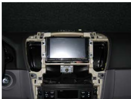
Mettre en place le nouvel autoradio et le fixer par ces 4 vis.
