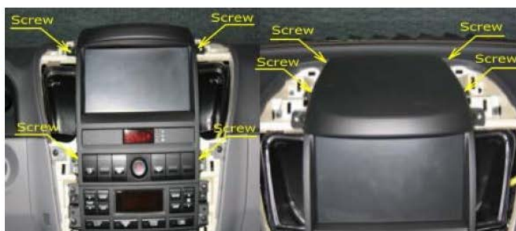
Enlever les 2 vis de fixation et retirer le panneau au dessus de l'autoradio.
