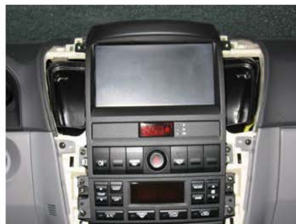
Déclipser les panneaux à droite et à gauche de l'autoradio
