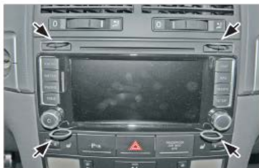
2- Mettre les 4 clés d'extraction pour enlever l'autoradio d'origine
