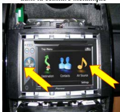
Glisser le système de navigation dans la ceinture métallique
