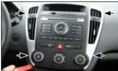
2. Déclipser le contour de l'autoradio à, l'aide d'un outil en plastique
