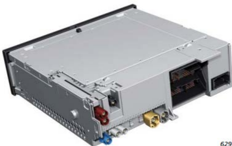
Face arrière du J794 avec MIB High et Audi connect
