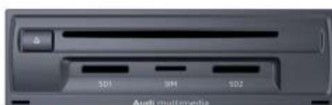
Façade du J794 sur la MIB High avec téléphone de voiture Bluetooth (lecteur de carte SIM)
