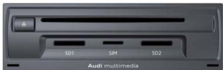
Face avant du J794 avec MIB High et Audi connect
