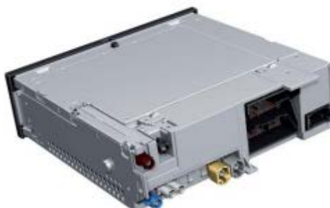
Face arrière du J794 sur la MIB High équipée d'Audi connect avec téléphone de voiture
