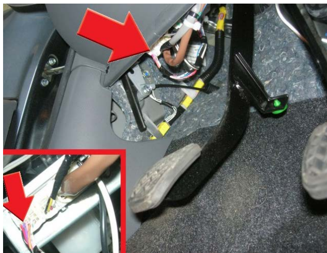
1° Vue du connecteur ECU avec Info vitesse :
