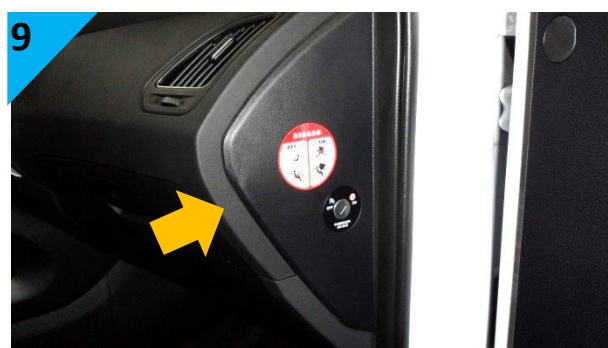
A l'aide de palettes en plastique, déclipper le cache droit sur le coté du tableau de bord
