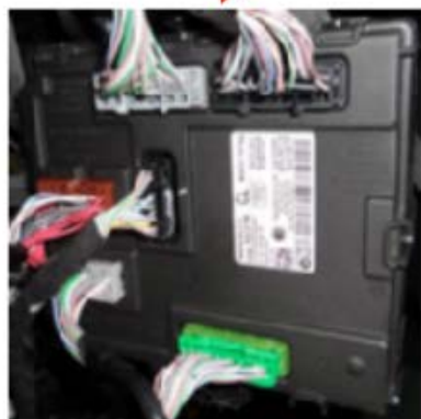
Vue de la centrale BCM
