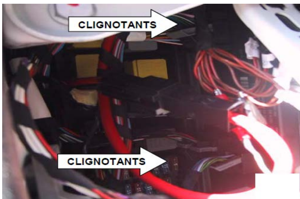
CLIGNOTANTS CONNECTEUR MARQUE X9 ET X3
