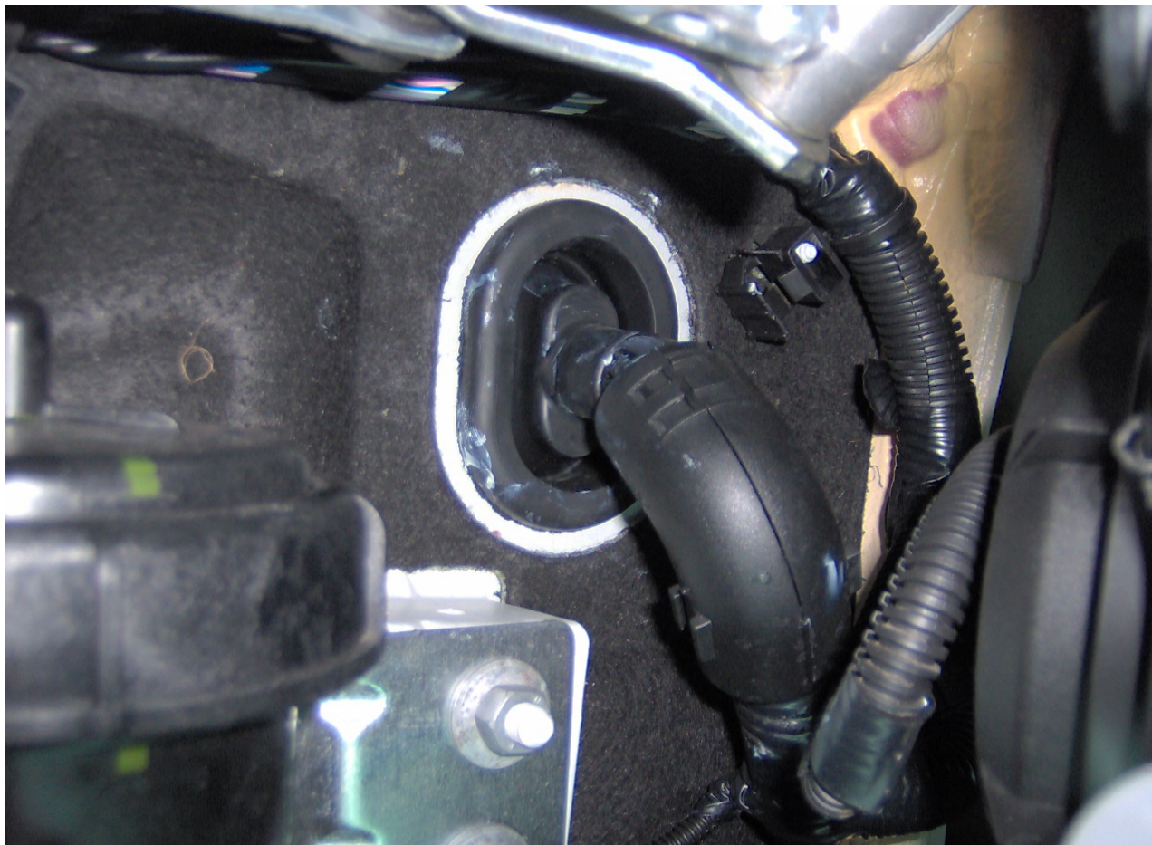
Connecteur : BLEU-ROUGE à 36 voies marqué « PG » sur l'arrière de la boîte à fusibles
