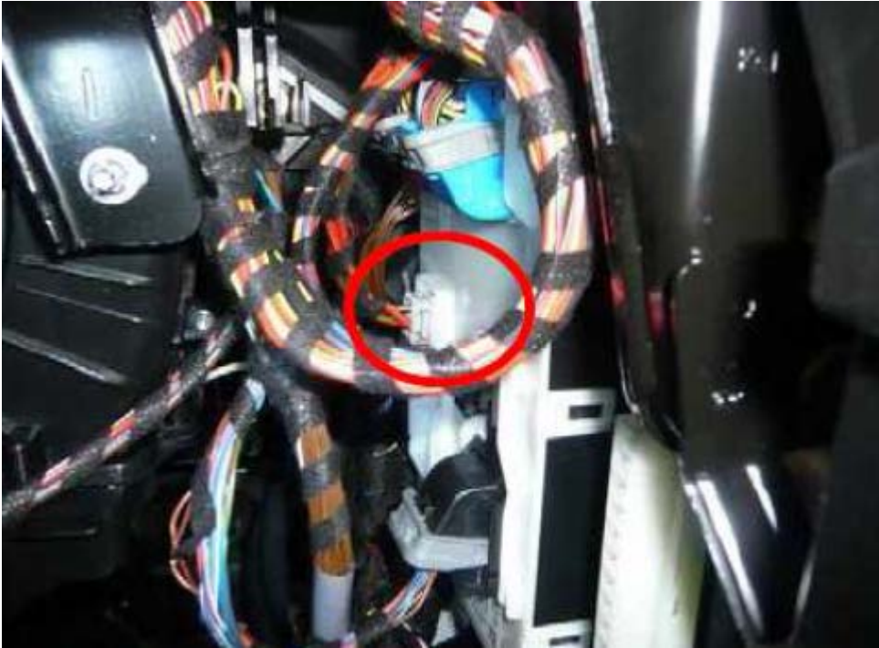
PHOTO2 Indicateurs de direction : connecteur BLEU à 48 voies et VIOLET à 48 voies
