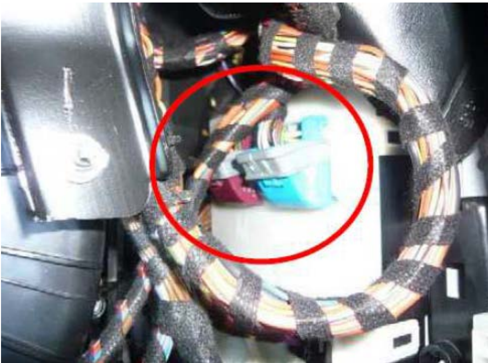
PHOTO2 Indicateurs de direction : connecteur BLEU à 48 voies et VIOLET à 48 voies
